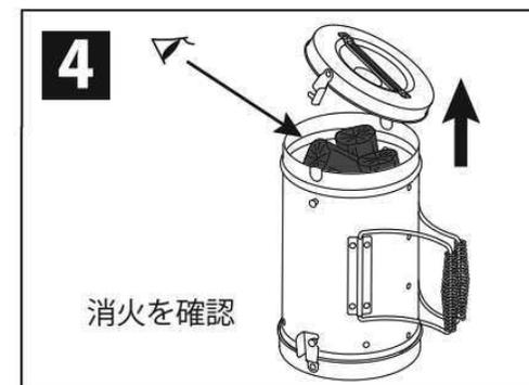
本体が完全に冷めたら、上のふたを開けて燃料の消火を確認してください。自然消火した炭は、再度炭として使用することができます。
